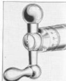
Fig. 226. Colar micrométrico do parafuso de avanço transversal
