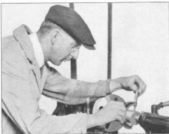
Fig. 111. Emprego do calibrador micrométrico exterior para medir o diâmetro da peça em laboração no torno
