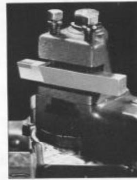
Fig. 88. Ferro com ponta de tungsténio-carbureto
