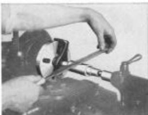
Fig. 265. Os sinais de ferramentas desaparecem com a limagem
