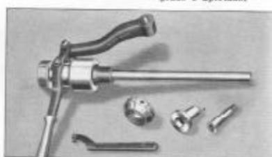
Fig. 168. Mandril de encavadoiro convergente com alavanca
