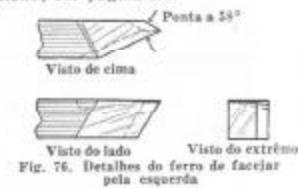
Fig. 76. Detalhes do ferro de facejar pela esquerda
