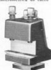
Fig. 311. Poste de ferramenta com abertura lateral
