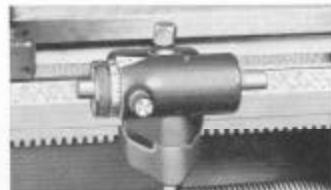
Fig. 310. Paragem micrométrica do carro
