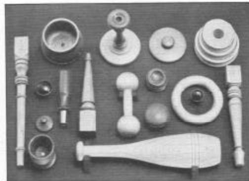
Fig. 342. Peças de madeira e fibra, executadas num pequeno torno para metais.
