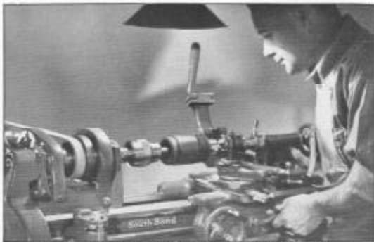
Fig. 327. Rectificação e cerceamento dum colector de induzido.
