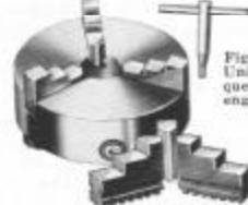
Fig. 150. Mandril Universal de 3 queixadas, com engrenagem em espiral
