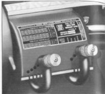
Fig. 211. Mecanismo de engrenagens de mudança rápida para abrir rosas
