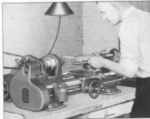
Fig. 341. Tornoamento de madeira num pequeno torno para metais.
