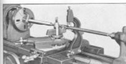
Fig. 285. (À esquerda). Filetadura dum veio longo e delgado com a luneta seguidora
