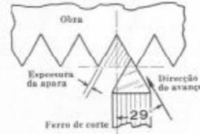
Fig. 223. Como trabalha o ferro de corte quando a luneta composta se inclina a  $29^\circ$
