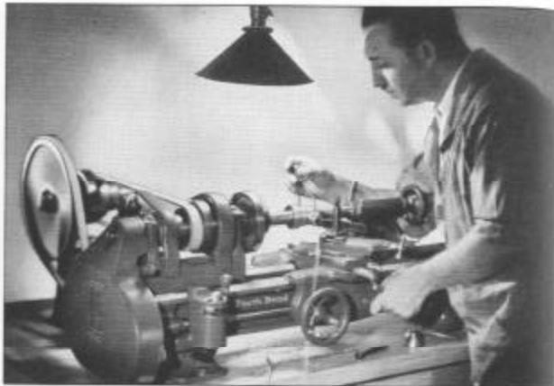
Fig. 339. Tornoamento em metal num pequeno torno mecânico de engrenagens redutoras.
