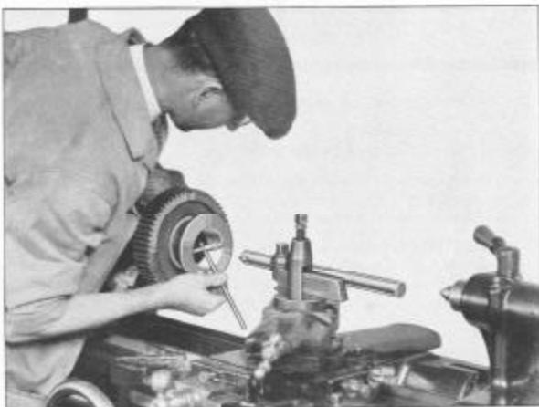
Fig. 112. Emprego do calibrador micrométrico interior para medir o diâmetro dum orifício aberto no torno
