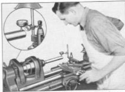
Fig. 104. Ensaio da árvore do cabeçote com a barra de prova e indicador de quadrante.
