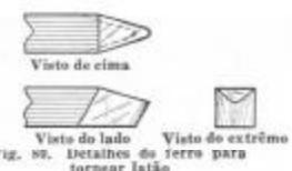
Fig. 80. Detalhes do ferro para tornear latão
