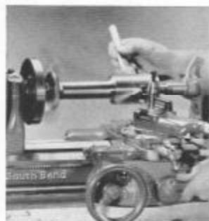
Fig. 238. Ao filetear no aço aplique-se óleo com um pequeno pincel
