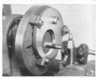
Fig. 261. Perfuração dum orifício desenhado no prato do torno
