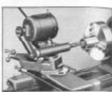
Fig. 316. Acessório para rectificação interna
