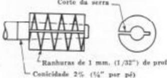
Fig. 268. Pulidor de ferro fundido para pó de esmeril
