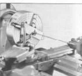
Fig. 153. Centragem duma peça por meio do indicador
