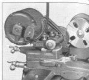
Fig. 315. Acessório para amolação externa
