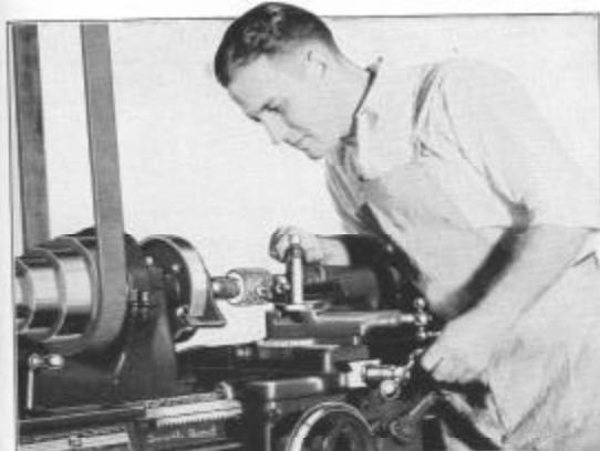
Fig. 204. Fileteando ou abrindo rosca ao torno
