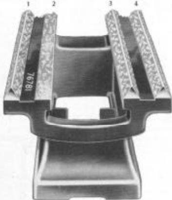
Fig. 20. Barramento de torno, em perspectiva, vendo-se os trilhos prismáticos.
