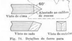
Fig. 78. Detalhes do ferro para abrir roscas
