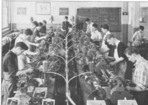
Fig. 358. Escola Técnica de Bristol, Conn., dotada de 18 tornos de banco South Bend, de precisão.
