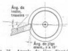
Fig. 56. Ângulo de jôgo dianteiro e inclinação traseira da ferramenta.
