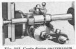
Fig. 303. Corte de uma engrenagem num torno
