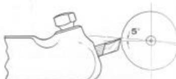
Fig. 51. Gume do ferro 5° acima do centro, para obra simples de torno.
