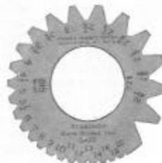
Fig. 216. Calibre múltiplo para amostra de ferramentas de filetear
