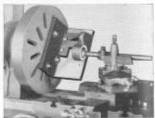
Fig. 262. Perfuração dum gombo de chapa rectangular no prato do torno
