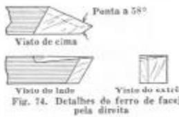
Fig. 74. Detalhes do ferro de facejar pela direita
