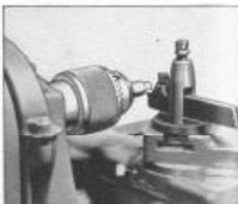
Fig. 159. Elaboração dum vaso num mandril óco de cabeçote fixo
