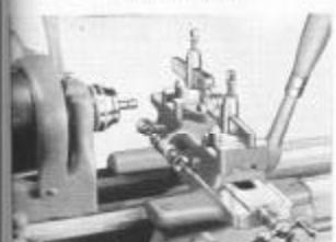
Fig. 293. Porta-ferramenta duplo, de alavanca manual
