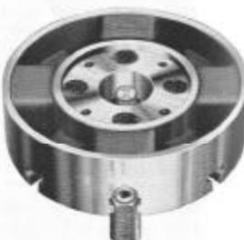
Fig. 347. Vista posterior de mandril sem o prato de furos
