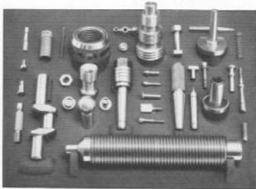
Fig. 340. Peças metálicas integralmente torneadas num torno de precisão com engrenagens redutoras, diâmetro de 9 pugs. (228 mm.)
