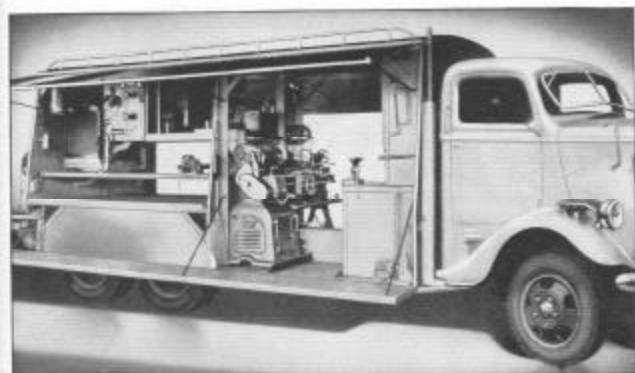
Fig. 338. Oficina mecânica ambulante instalada num caminhão
