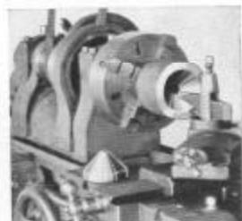
Fig. 172. Luneta composta ajustada ao ângulo, para tornear e perfurar cônicos
