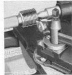
Fig. 222. Filetadura com luneta composta inclinada a  $29^\circ$
