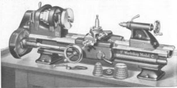
Fig. 4. Torno moderno, de banco, com avanço a parafuso de engrenagem.
