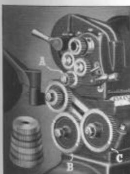
Fig. 23. Mecanismo da engrenagem de mudança manual
