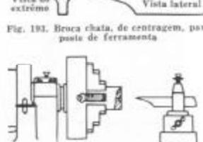
Fig. 194. Uso da broca chata de centragem no poste de ferramenta
